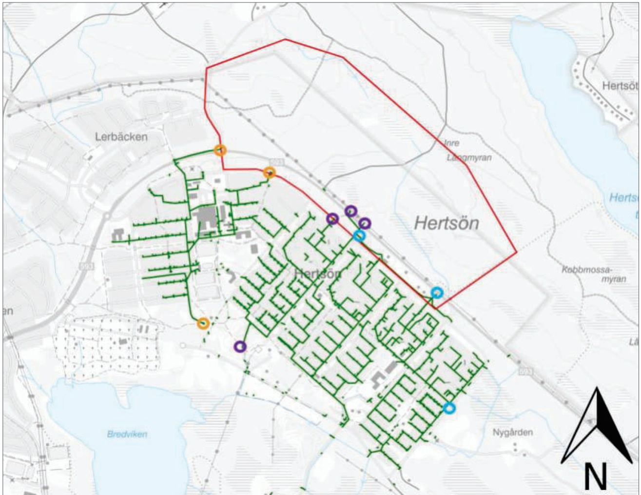
Figur 14. Karta över befintligt ledningsnät inom och nedströms Hertsöheden. De färgade cirkarna indikerar var olika delar av Hertsöheden har sin respektive utsläppspunkt nedströms (Tyréns, 2024).
